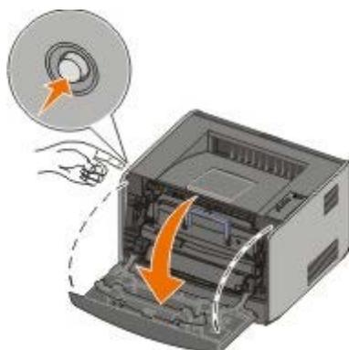
2. Drücken Sie auf den Knopf an der Druckkassetteneinheit, und ziehen Sie die Druckkassette am Griff heraus.
