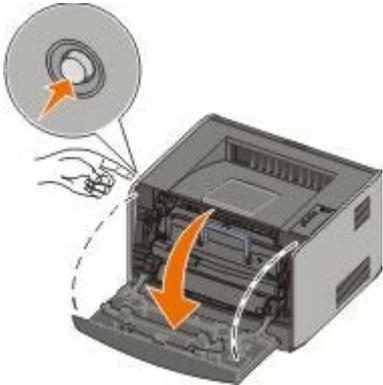
3. Nehmen Sie die Druckkassetteneinheit aus dem Drucker heraus, indem Sie am Griff der Druckkassette ziehen.
