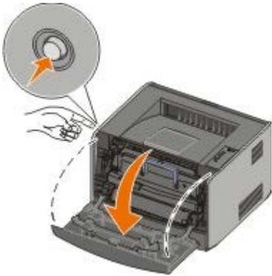
2. Drücken Sie auf den Knopf an der Unterkante der Druckkassetteneinheit.
